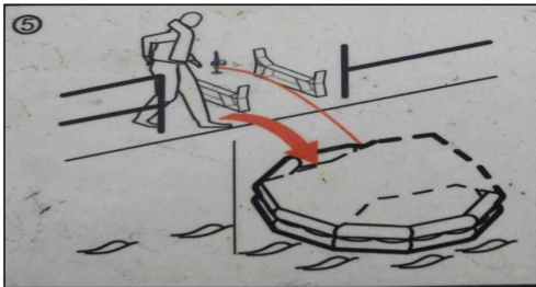
슬라이드 설치 후 구명뗏목으로 뛰어내린다.
